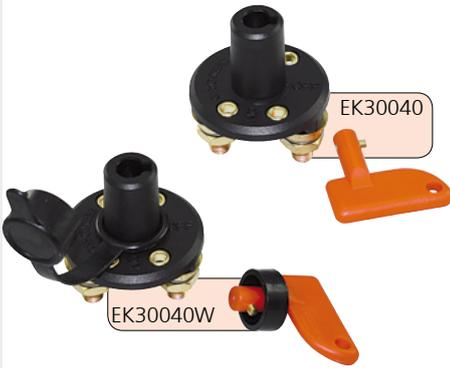
Batterieschalter für 1 Batterie, Spannung: 6-32V, Dauerlast: 12V-75A, max. Spitzenlast: 12V-500A
