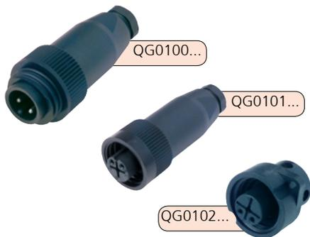
Wasserdichte Rund-Steckverbinder aus Kunststoff PBT-gv. Schutzklasse nach VDO 0470 entspricht IP67. Die Kontakte sind für einen optimalen Kontakt versilbert. Spannung bis max. 50 V.
