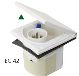
CEE Einbaustecker 230 V - 16 A - 3 polig, IPx4 spritzwassergeschützt mit Zugentlastung und Kabelknickschutz. Kunststoffkappe mit Bajonettverschluss in Metalloptik
