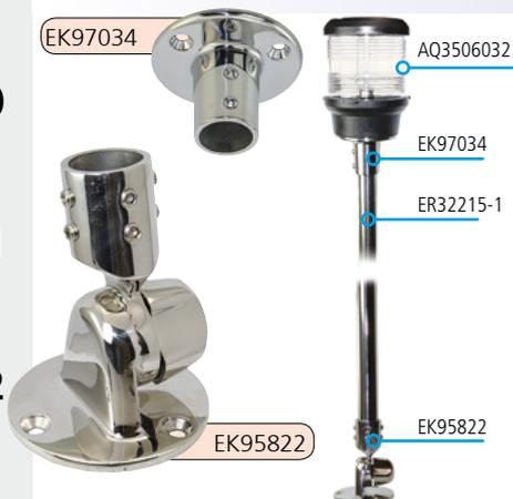
Klappbare Halterung für Topplicht Beleuchtungsmasten, Flaggenstock usw. aus Edelstahl 1.4404. Passend für Rohr mit 22 mm Außendurchmesser. Ausgestattet mit einem Kabelauslass mit 7 mm im unteren Bereich der Rohrhalterung für eine innenliegende Kabelführung. Das Rohr wird mit sechs Madenschrauben fixiert und austariert. Durch den Zahnkranz kann der gewünschte Winkel eingestellt und fixiert werden.
