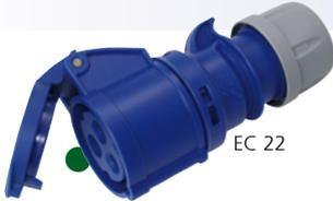
CEE Kupplung 230 V - 16 A - 3 polig, IP44 spritzwassergeschützt
