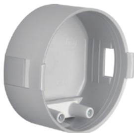
Berührungsschutzdose mit 45 mm Ø. Vier Leitungsöffnungen für bis zu 12 mm Ø und einer Einbautiefe von 35,5 mm. Ausgestattet mit einer Zugentlastung. Schwer entflammbar nach VDE0606-1.
