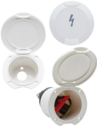
Batterieschalter mit Gehäuse aus ASA, für 1 Batterie, Spannung: 6-32V, Dauerlast: 12V-100A, max. Spitzenlast: 12V-1000A
