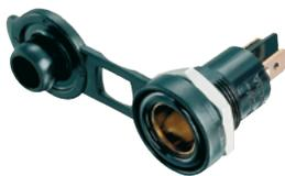
Einbau Normsteckdose mit Deckel zum Schutz vor Staub und Spritzwasser. Passend für Norm- und Universalstecker. Einbauloch.Ø 16 mm, Gewindelänge 8 mm.
