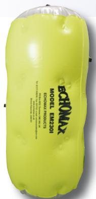
Spezielles metallbeschichtetes Spinnvlies innerhalb der aufblasbaren PVC Hülle. Kann nach Ablassen der Luft extrem klein zusammengefasst werden und bietet sich als Notfall Radarreflektor an. QinetiQ stellte einen max. response von 17 m<sup>2</sup> fest. Damit werden die Vorgaben der RORC von 10m<sup>2</sup> erfüllt. Für den Gebrauch auf einer Rettungsinsel oder in einem Dinghi ist ein Befestigungsset mit 3 Glasfaserstäben erhältlich.  $\alpha$  +/- 3° - 17 m<sup>2</sup> Max. Reflektionsfläche.
