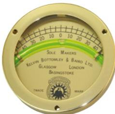
Traditioneller Krängungsmesser aus Messing, der nach dem Prinzip der Wasserwaage funktioniert.
